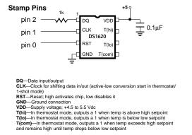
Figure 2. DS1620 pinout and connection.
