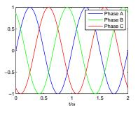
$$i_A(t) + i_B(t) + i_C(t) = 0, \quad \forall t$$
