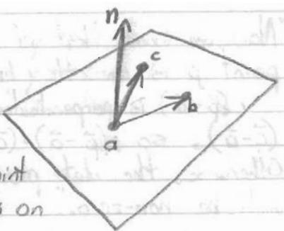
$$\begin{aligned}\vec{n} &= (\vec{b} - \vec{a}) \times (\vec{c} - \vec{a}) \\ \vec{n} \cdot (\vec{p} - \vec{a}) &= 0\end{aligned}$$
